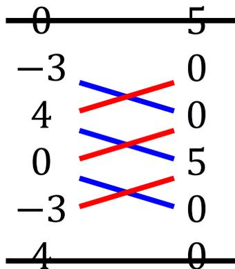
$$\underline{\vec{n}} = \vec{u} \times \vec{v} = \begin{pmatrix} -3 \cdot 0 \\ 4 \cdot 5 \\ 0 \cdot 0 \end{pmatrix} - \begin{pmatrix} 4 \cdot 0 \\ 0 \cdot 0 \\ -3 \cdot 5 \end{pmatrix} = \begin{pmatrix} 0 \\ 20 \\ \underline{15} \end{pmatrix}$$
